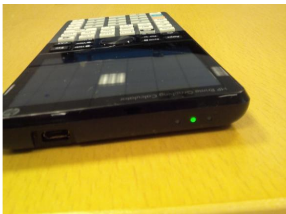
Figure 2 - clignotement unique de la diode verte en mode d'examen
